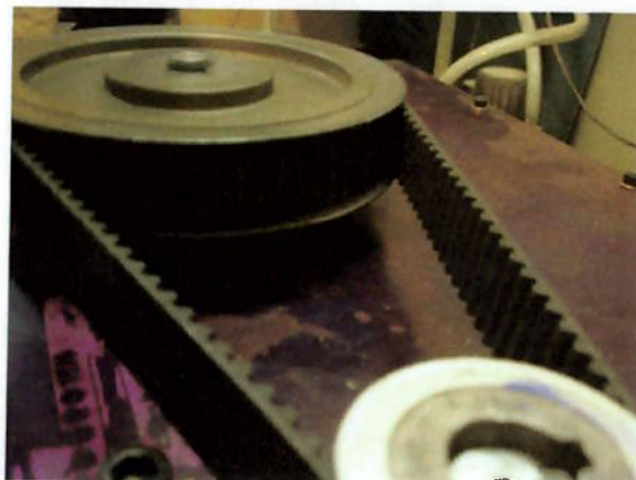
Figura 42 – Detalhe da redução primária.
